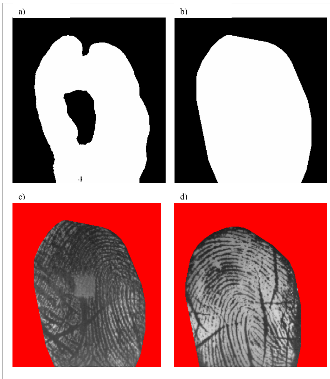
Abbildung 4.10: Konvexe Hülle eines Fingerabdrucks. a) Segmentierter Hintergrund b) konvexe Hülle des Fingerabdrucks c) das Originalbild aus der Abb. 22 mit rot maskiertem Hintergrund d) das Originalbild a) aus der Abb. 20 mit rot maskiertem Hintergrund.
