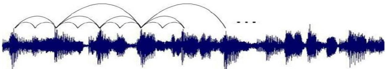
Abb.17: Aus der Wellenform werden Onsets entnommen und in einer metrischen Struktur untergebracht (Bögen oberhalb)
