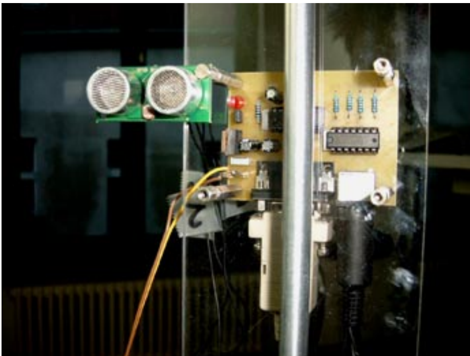
Abb. 21 : Ultraschallsensor mit Interfacekarte
