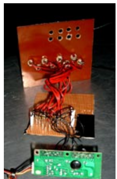
Abb. 20 : Aufbau des Prototyps der Trittmattensteuerung
