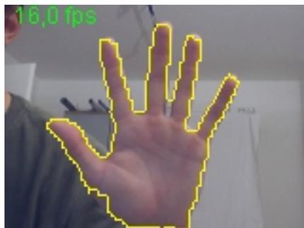
(c) Sehr gute Konturfindung bei ausschließlich indirektem künstlichen Licht
