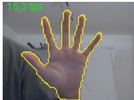
(b) Sehr gute Konturfindung bei abgedunkeltem Raum und indirektem künstlichen Licht
